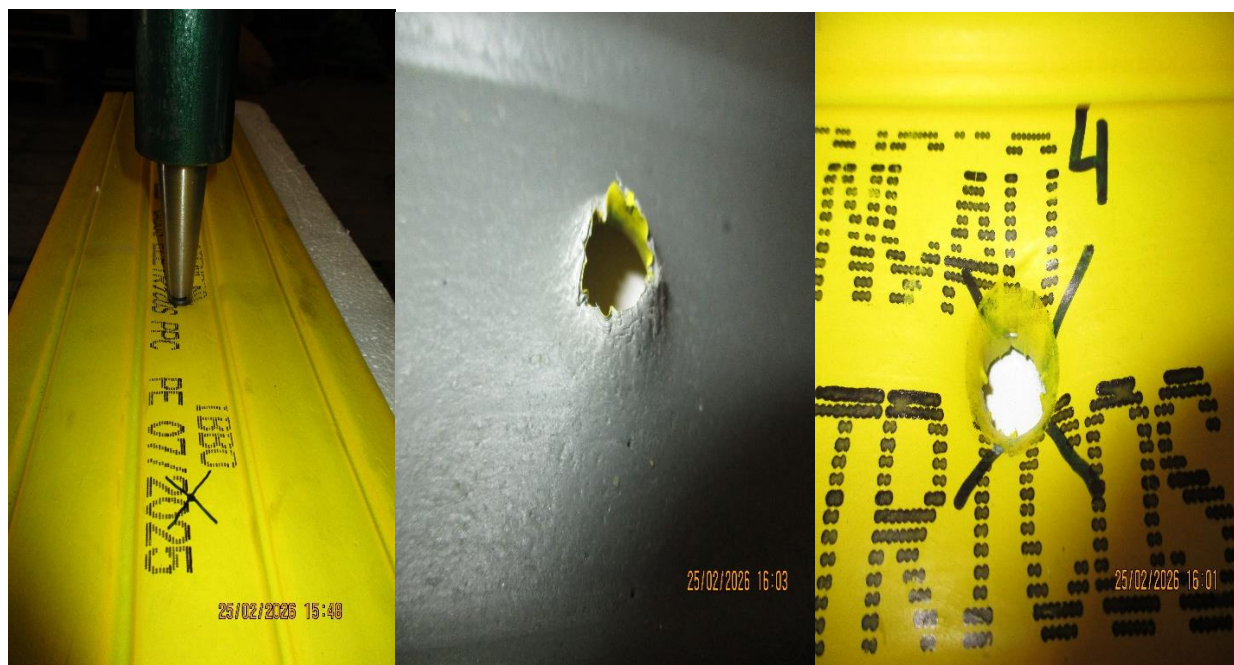
Figura 3 - Ensaio de Impacto das placas PPC-PE
