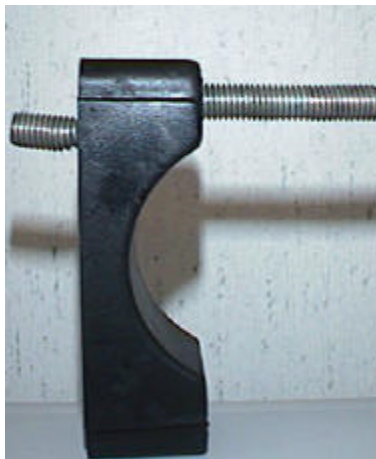
Imagen de la varilla tras un ensayo en el que la pieza no mostró daño alguno
